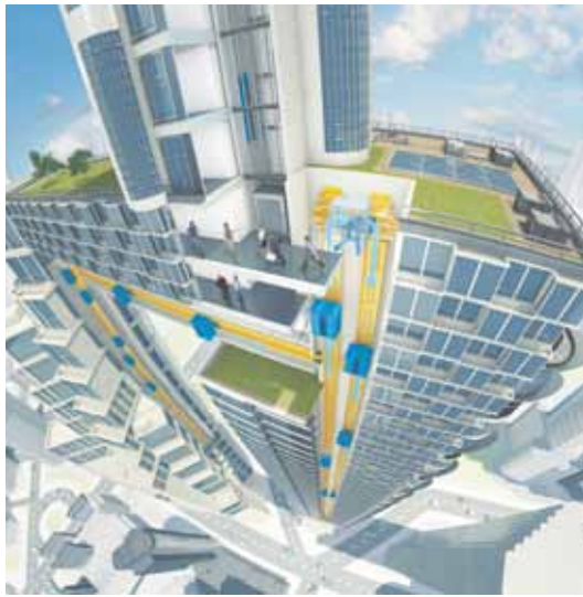
Sopra, il sistema Multi di ThyssenKrupp, ancora in fase di test, che permetterà anche il movimento in orizzontale degli ascensori. A sinistra, Twin, con due cabine, una sopra l'altra, che si muovono indipendentemente
